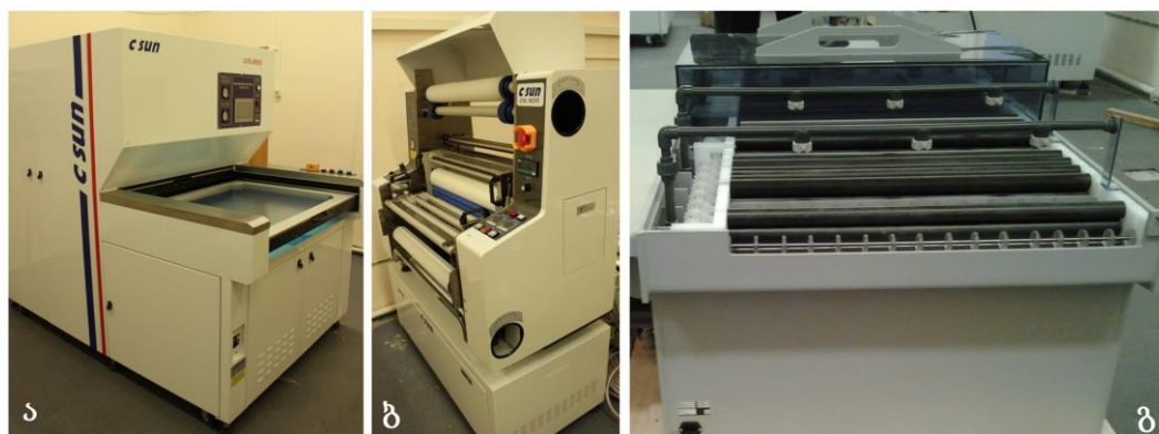
სურ.17-13: მიკრომეგას-კამერების ფოტოლითოგრაფიის დანადგარები დუბნის (LNP, JINR) დეტექტორების საწარმოო უბანზე
