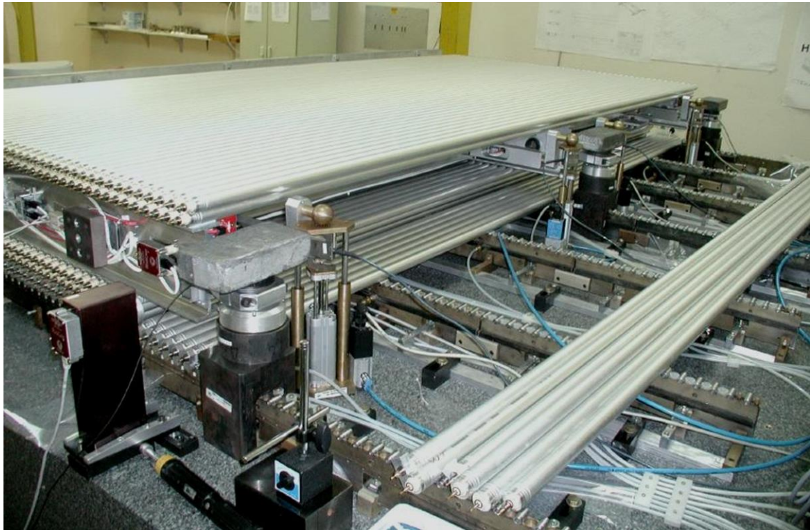
სურ.15-16: MDT დრეიფული კამერის აწყობის მომენტი დუბნის ბირთვული კვლევის გაერთიანებულ ინსტიტუტში ოპტიკო-მექანიკურ, გრანიტის ზუსტ მაგიდაზე (2001 წ.)
