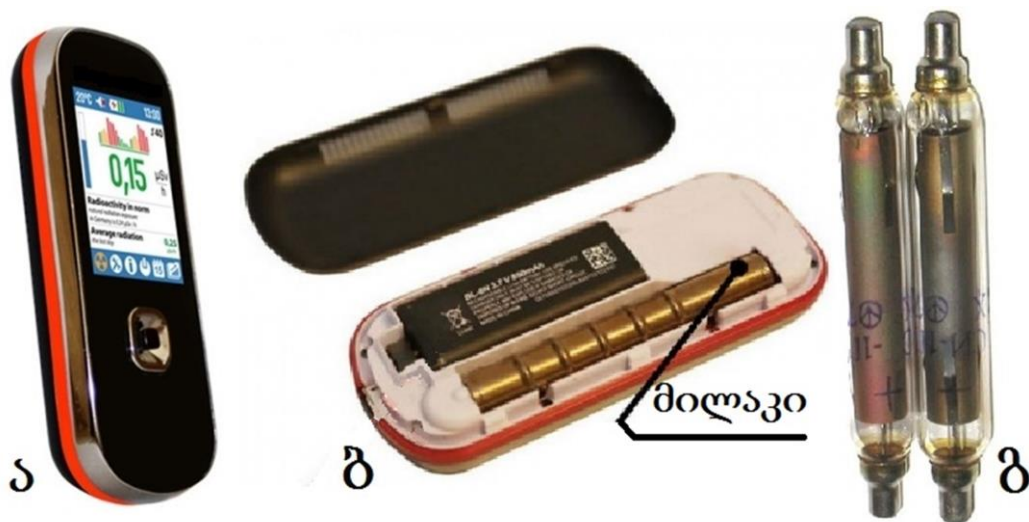
სურ.15-17: გეიგერის მთვლელის დოზიმეტრი (ა), მთვლელი დოზიმეტრის კორპუსში (ბ); მინის კედლის მთვლელები (გ)
