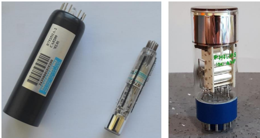
სურ.10-1: ჰამამაცუ R7525, R760 და Philips 150 AVP ფოტოგამამრავლებელი მილაკები
