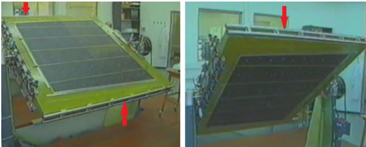
სურ. 15-8: მავთულოვანი ელექტროდის ხრახნულეებზე დახვევა (გეისმანის ინსტიტუტი, რეჰოვოტ, ისრაელი) 1999 წ.
