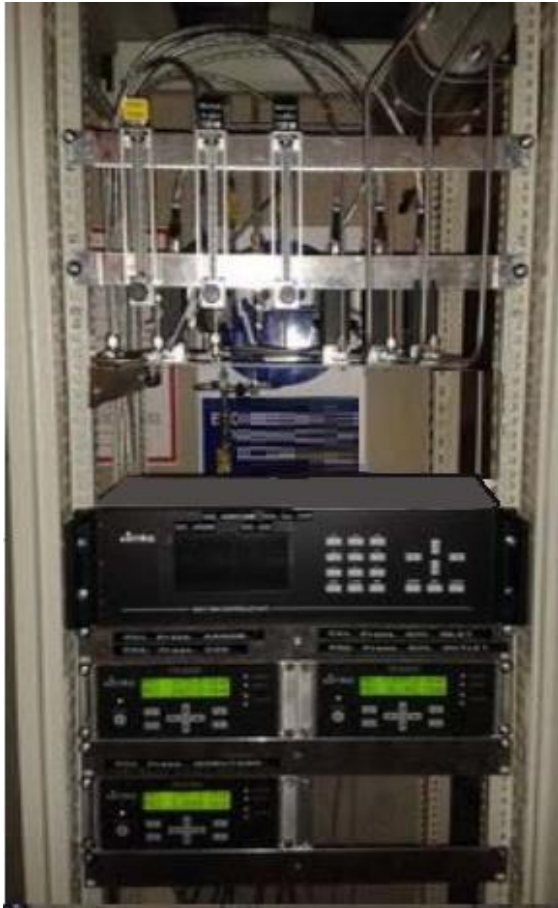
სურ.19-3: ავტომატიზირებული გაზური პულტი (KLOE, INFN, 2013)
