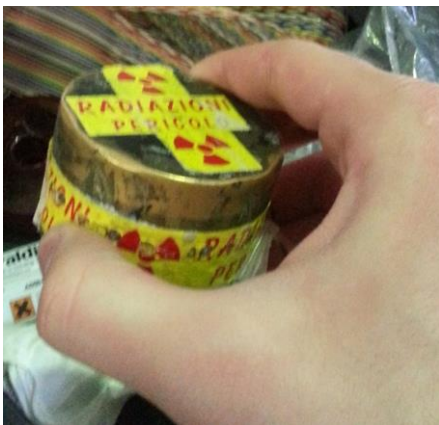
სურ.2-1: ლაბორატორიული რადიაქტიური წყარო ტყვია-თითბრის კორპუსში
