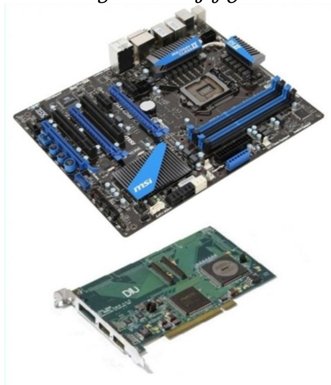
სურ.18-14: PCI ინტერფეისი (ზემოთ) და PCI მოდული (ქვემოთ)
