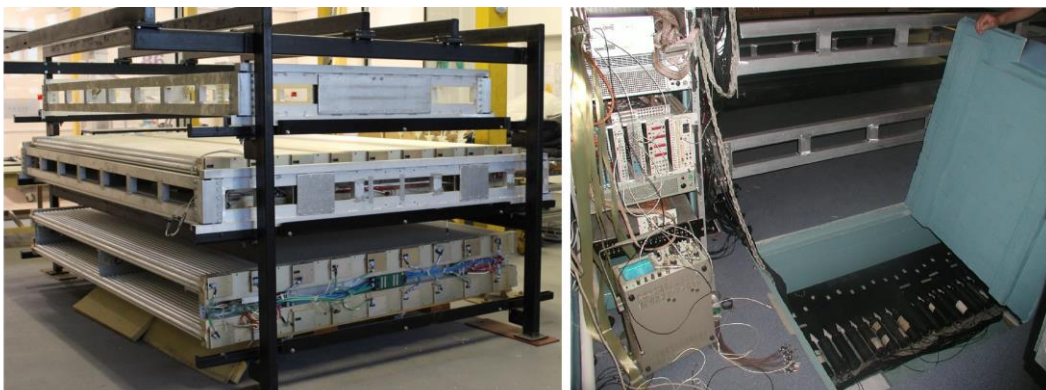
სურ.20-6: ხუთდონიანი სტენდი MDT- რეპერული კამერებით (დუბნა, LNP, JINR) და იატაკის ქვეშ განთავსებული სცინტილატორული მთვლელების მესერი
