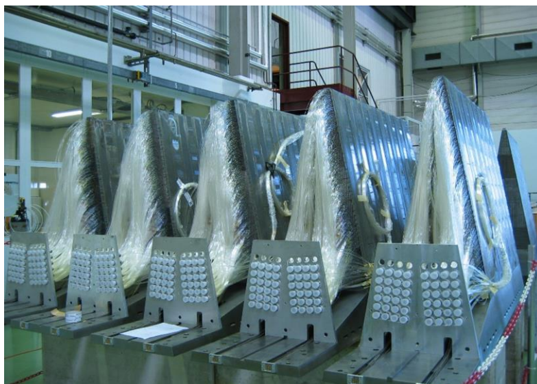
სურ.13-14: CMS ექსპერიმენტის წინა ადრონული კალორიმეტრის (HF - Hadron Forward) სოლისებური მოდულები.
