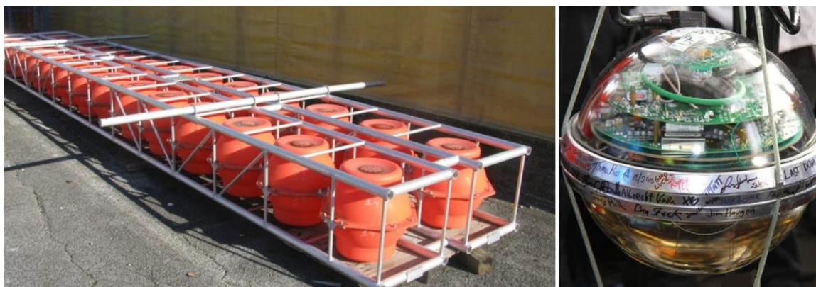
სურ.3-1: ანტარქტიდის ექსპერიმენტის ფოტოგამამრავლებლები
